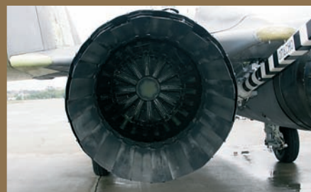
Форсажная камера модернизированного двигателя РД-33МК и посадочный гак
