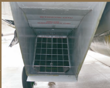
Защитная решетка в канале воздухозаборника: на серийных МиГ-29 такого не было
