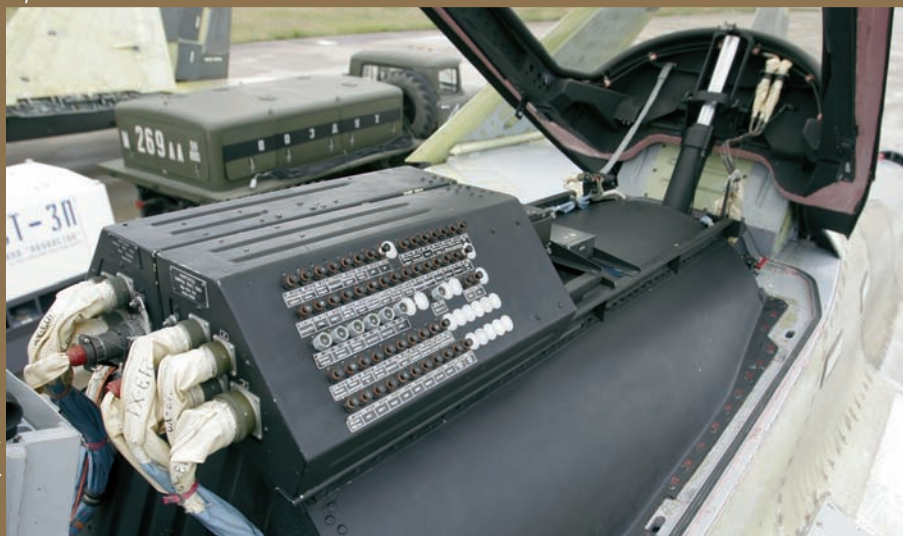
На месте второго летчика в одноместном МиГ-29К находится дополнительный топливный бак и блоки электрооборудования
